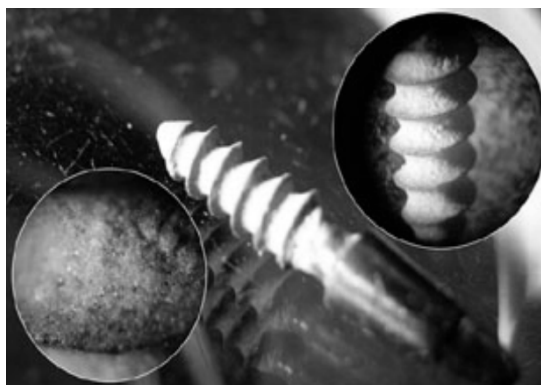
Рис. 1. Дентальный имплантат, обработанный микродуговым оксидированием [4]
